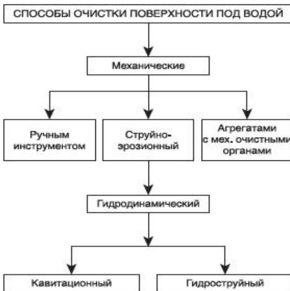
Рисунок 5.2 – Основные механические способы очистки поверхности от обрастания
