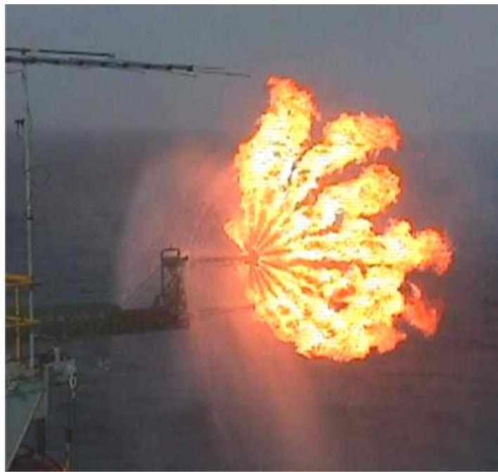
Рисунок 5.1 – Водяной защитный экран факельной горелки
